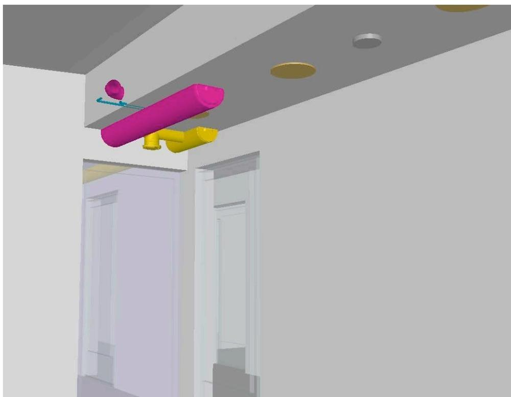
Figura 4.7.5: Ejemplo de modelado no permitido. O los conductos de ventilación deben ser elevados, o el falso techo se debe bajar.
