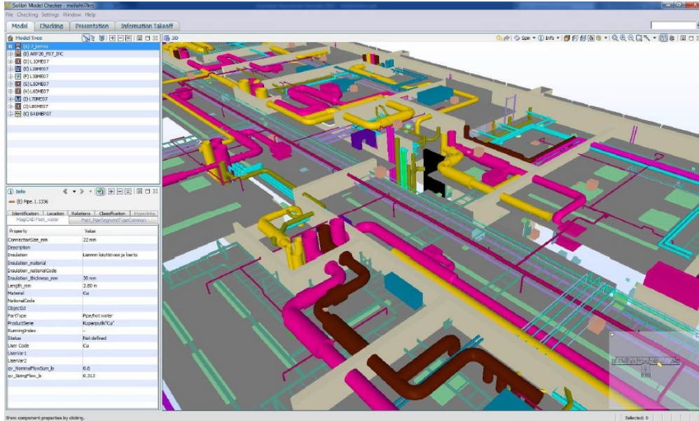
Figura 5. Un ejemplo de visualización de espacios, estructuras y sistemas técnicos por Vistas 2D / 3D de los modelos combinados.
